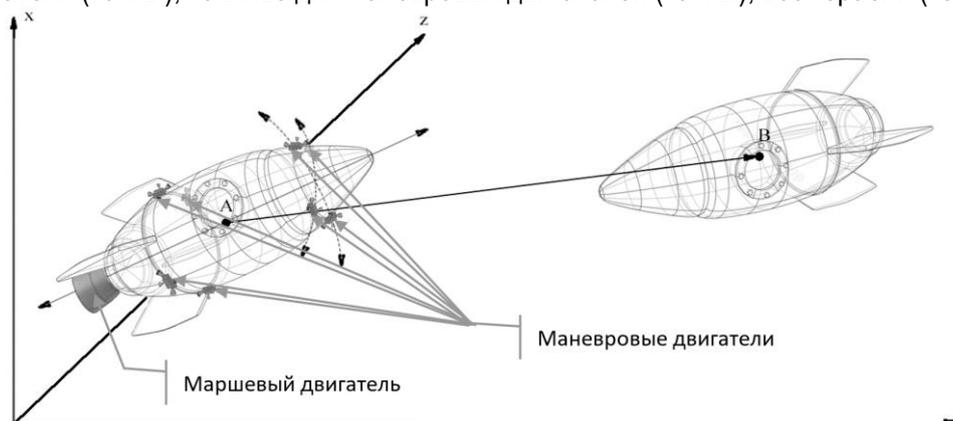
Маневровые двигатели необходимы для поворота космического корабля вокруг его центра масс (считаем, что центр масс находится в самом центре космического корабля). Поворот осуществляется путем создания импульса для начала поворота и импульса для остановки поворота. Блок маневровых двигателей состоит из 4х (можно двух) реактивных двигателей, направленных в разные стороны.
